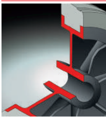
Mozzo con foro passante. Hub with plain bearing
